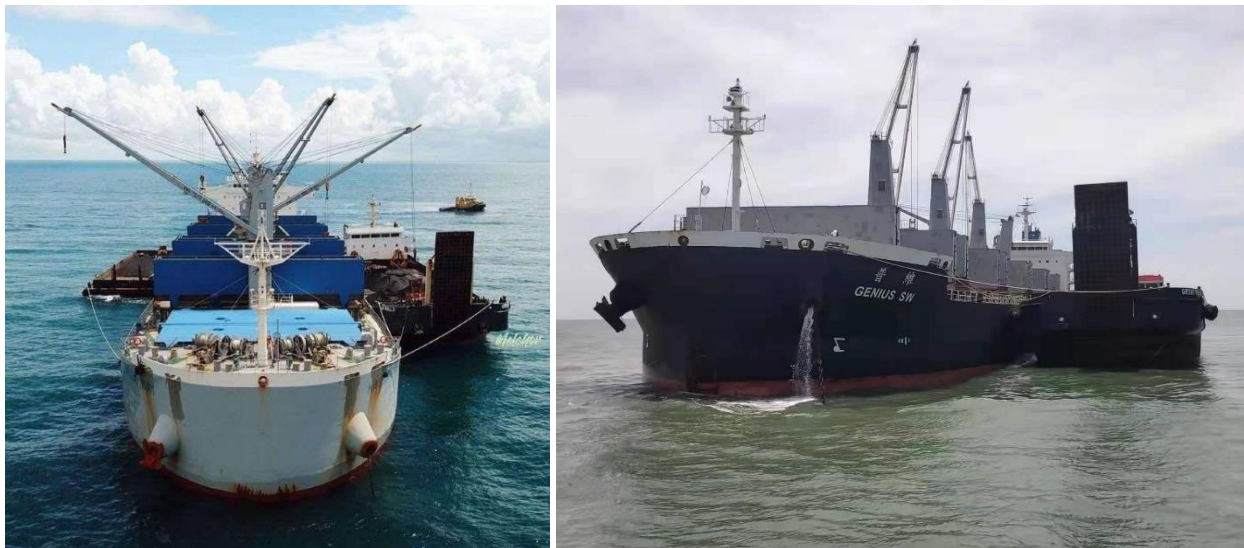
Figura 11. Transferência de materiais entre o barco de carga e o navio graneleiro
