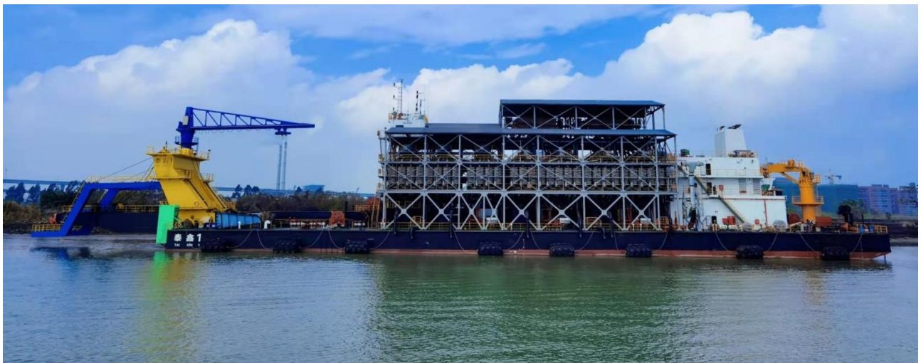
Figura 13. Vista geral do barco de mineração: divisão da draga à esquerda e divisão de separação à direita
